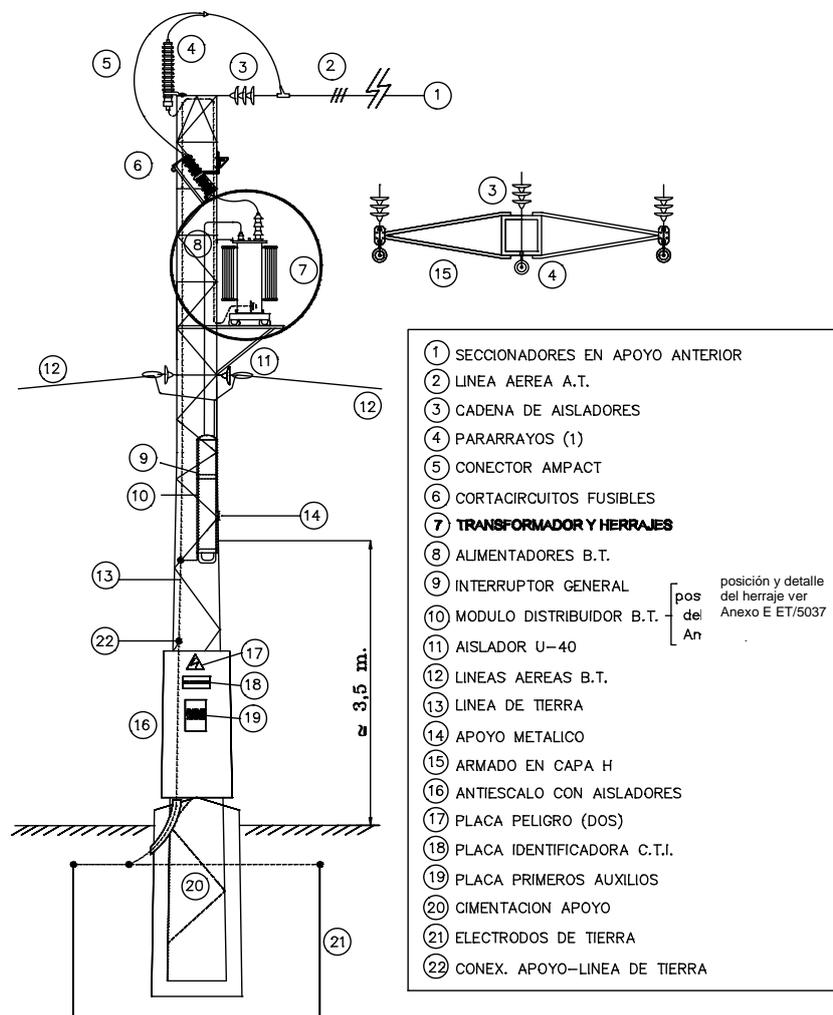
1) Además de la solución del dibujo, por derivación del puente cadena-transformador, se permite la toma directa del puente mediante borne-terminal estilo bandera.
