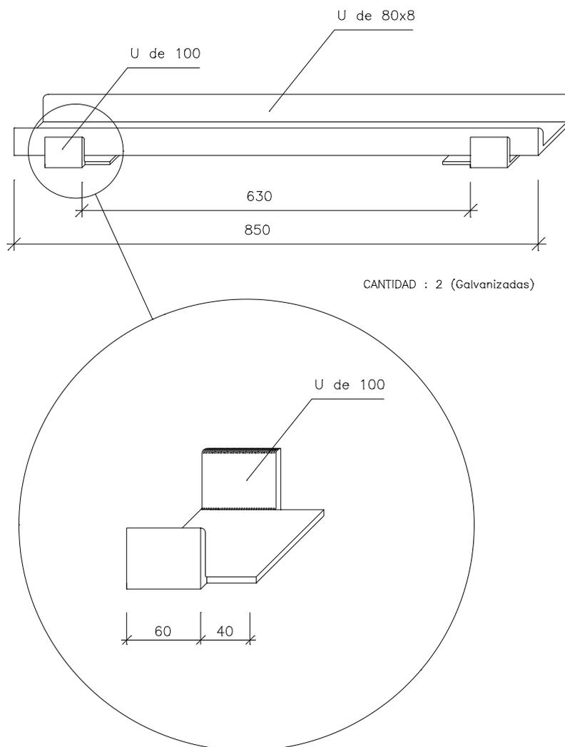
\* Cegar los extremos de la U con chapa soldada de 5 mm de espesor
